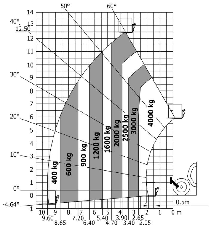
Drehung mit abgesenkten Stützen mit Gabeln
